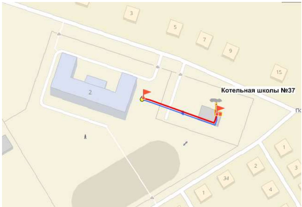
Рисунок 56 – Путь движения теплоносителя от источника тепловой энергии до конечного потребителя, в зоне действия котельной школы №37 (рисунок П46.1 МУ)
