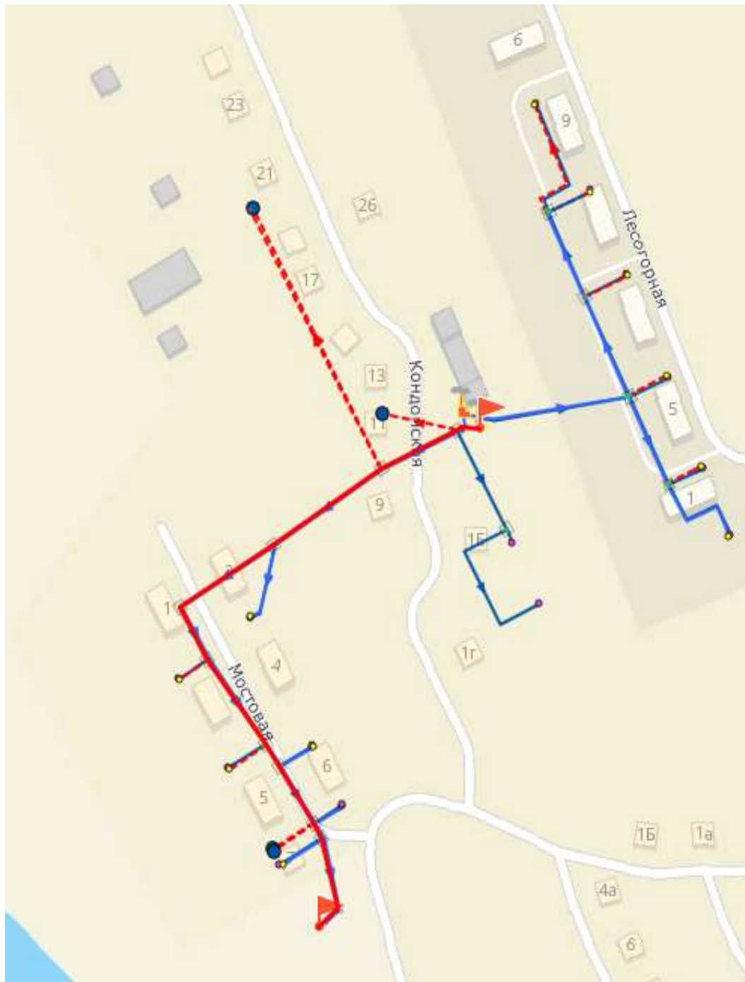
Рисунок 42 – Путь движения теплоносителя от источника тепловой энергии до конечного потребителя, в зоне действия котельной №1 п. Разъезд-Абагуровский (рисунок П46.1 МУ)
