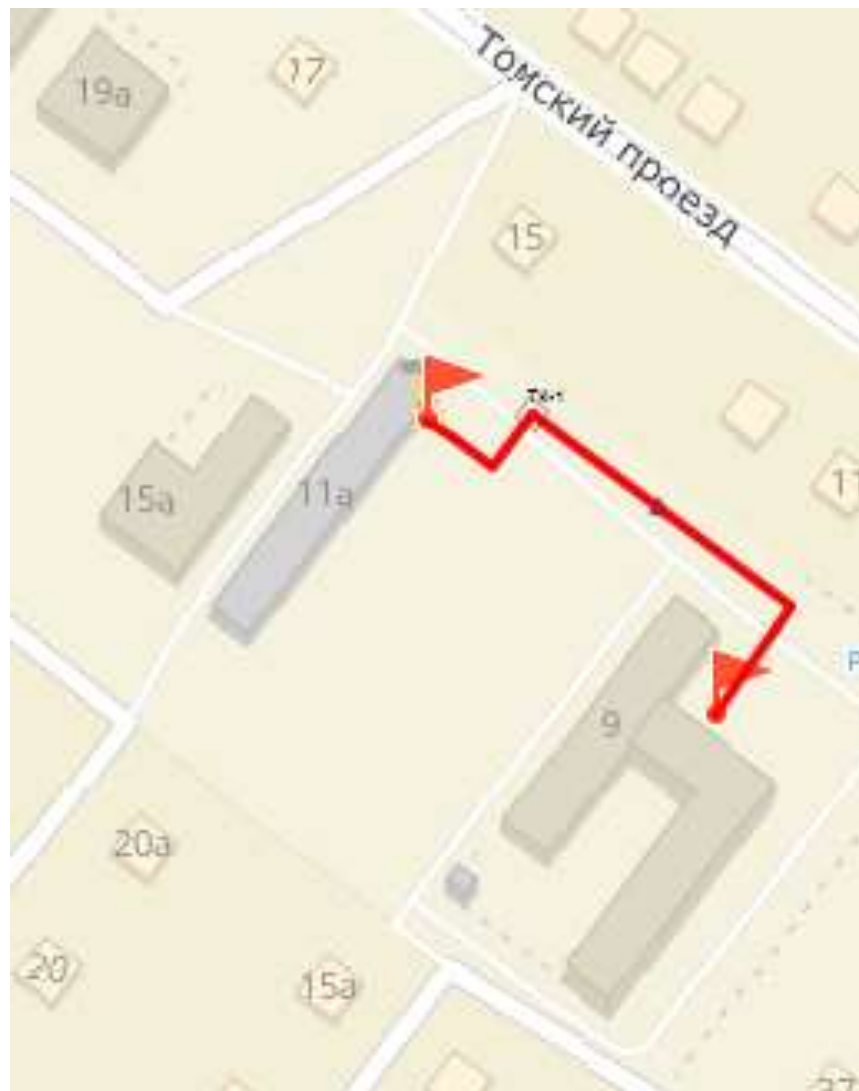
Рисунок 30 – Путь движения теплоносителя от источника тепловой энергии до конечного потребителя, в зоне действия котельной УПК (рисунок П46.1 МУ)
