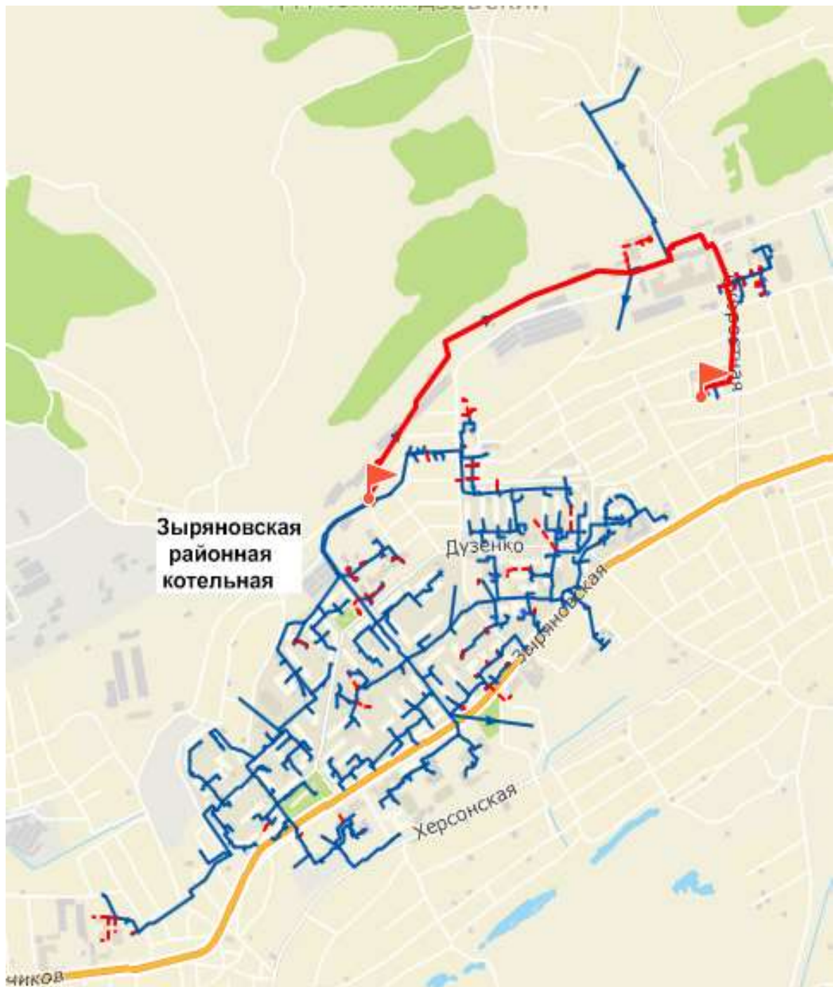
Рисунок 23 – Путь движения теплоносителя от источника тепловой энергии до конечного потребителя, в зоне действия Зыряновской районной котельной (рисунок П46.1 МУ)
