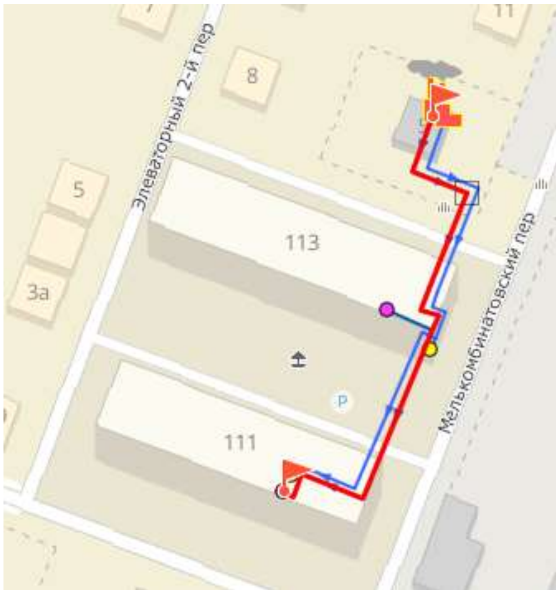
Рисунок 66 – Путь движения теплоносителя от источника тепловой энергии до конечного потребителя, в зоне действия котельной НКХП (рисунок П46.1 МУ)
