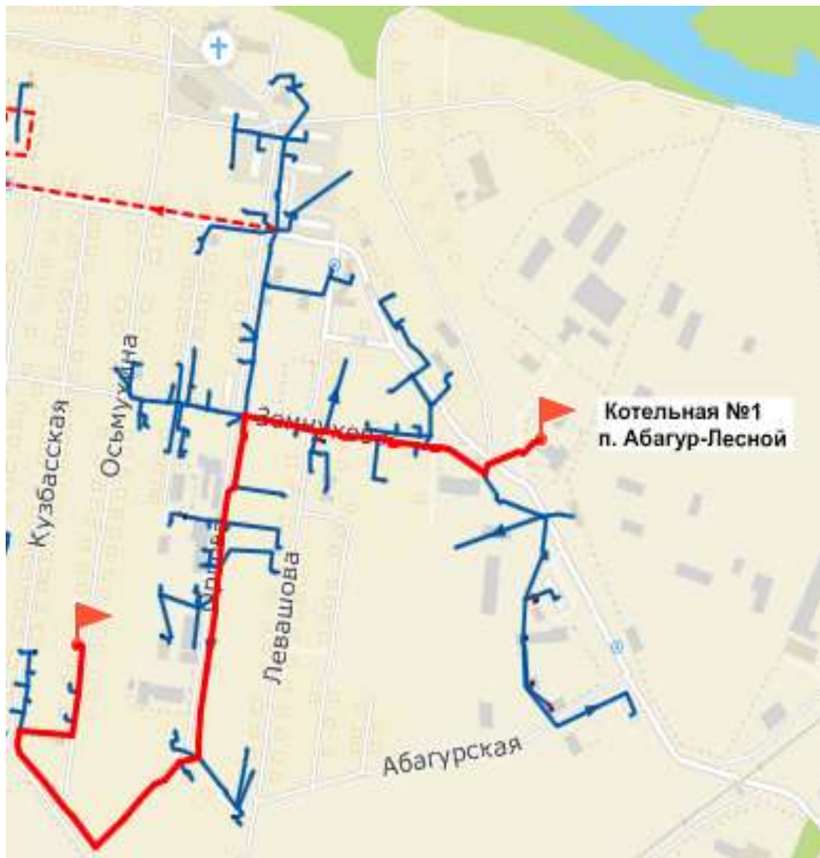
Рисунок 34 – Путь движения теплоносителя от источника тепловой энергии до конечного потребителя, в зоне действия котельной №1 п. Абагур-Лесной (рисунок П46.1 МУ)
