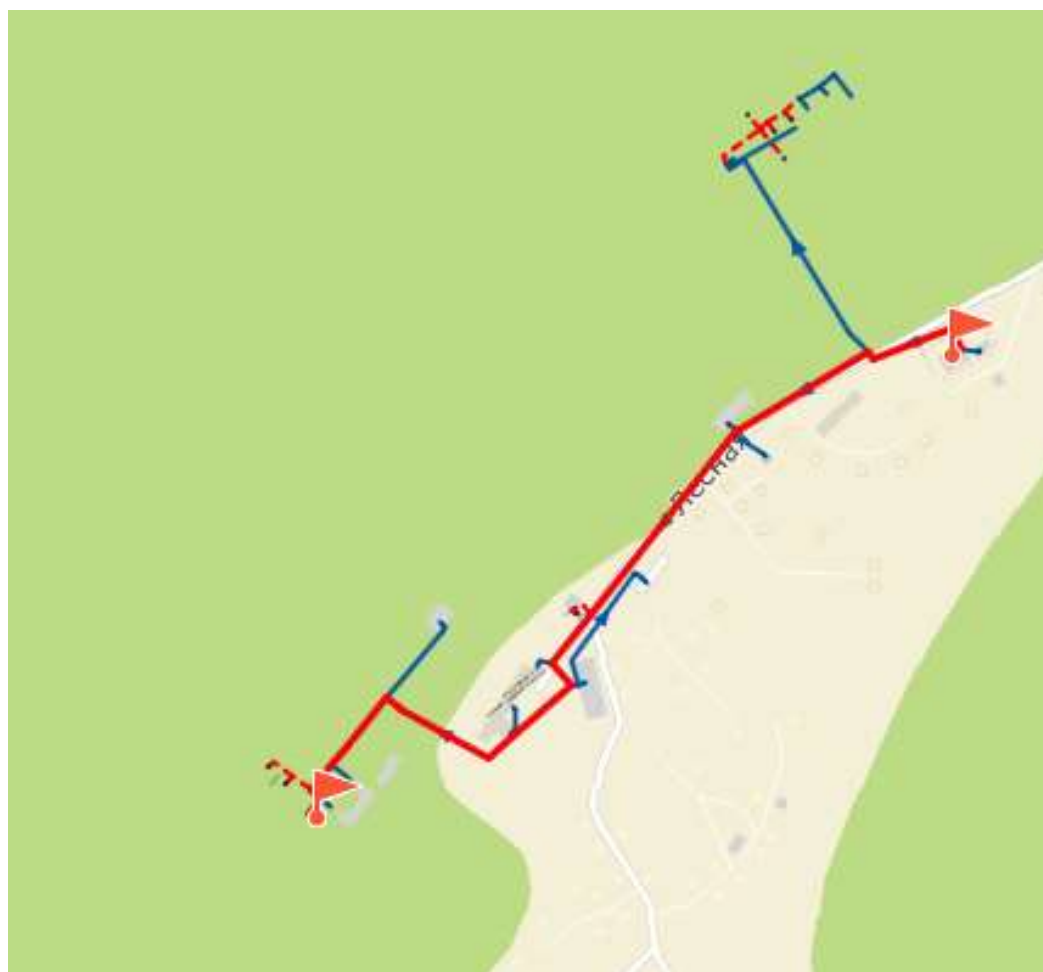
Рисунок 32 – Путь движения теплоносителя от источника тепловой энергии до конечного потребителя, в зоне действия котельной ОРК «Таргай» (рисунок П46.1 МУ)
