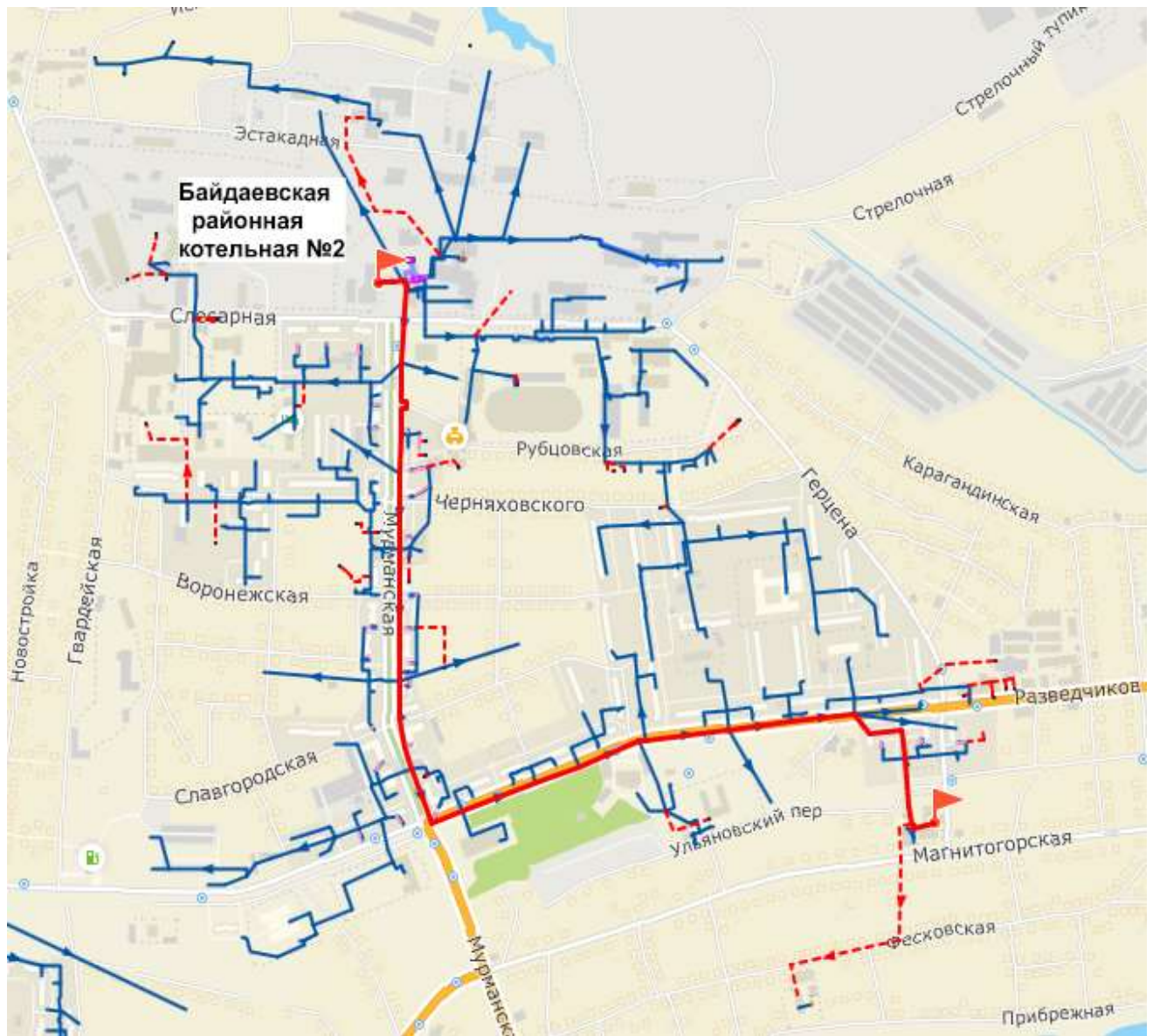
Рисунок 21 – Путь движения теплоносителя от источника тепловой энергии до конечного потребителя, в зоне действия Байдаевской центральной котельной №2 (рисунок П46.1 МУ)
